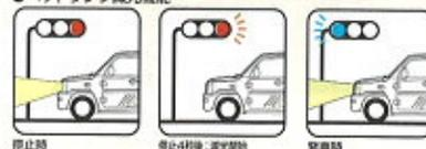
センサーが周囲の明るさを判断して自動的に点・消灯するオートライト機能と、信号待ちや渋滞などの一時停止時にヘッドランプを自動的に減光させるシステム。一度オートにセットすれば、ライティングスイッチのすべての操作が不要となり便利です。右折時や急ブレーキの際は、100%点灯する安全機能付。
