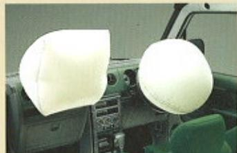
※写真はGパッケージ車。機能説明のためにデュアルSRSエアバッグが作動した状態を再現したものです。
