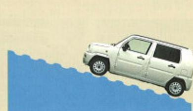
ネイキッドの4WD車は、フルタイム4WDだから切り替え操作は不要。リヤデフ部の回転差感应式カップリングが、前後輪の回転差を感知して駆動力の配分を自動的に調整。滑りやすい道や悪路でも、つねに安定した走行ができます。
